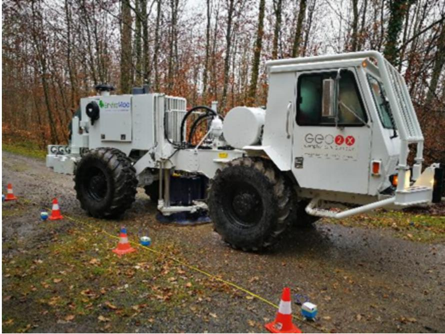
Figure 42: Exemple de sécurisation et signalisation du matériel sismique au croisement d'une route traversée par une ligne d'acquisition sismique très haute résolution.
